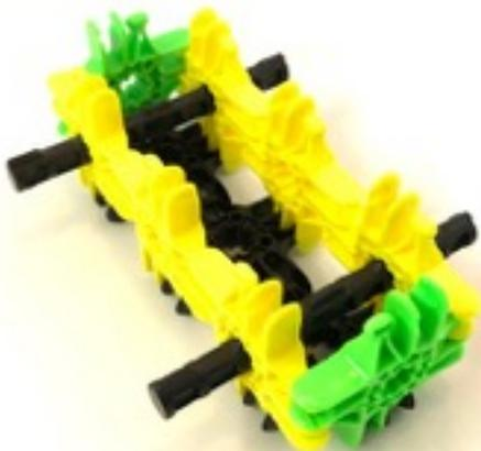
6 : シャフトの凹んだ部分が外にでるように調節します。
